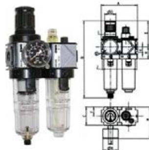
Gruppi di 2 unità. Tipo compatto per lo sfruttamento di spazi ristretti. Costruzione di nuova concezione modulare. Bicchieri in robusto policarbonato trasparente, infrangibile, a sgancio rapido, per temperature fino a 50 °C e pressioni fino a 16 bar. Con dosatore dell'olio in policarbonato.
